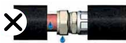
Laat verbindingen niet blootstaan aan condensatie
